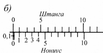
Рисунок 2 – Нониус: a – размер равен 0 мм; б – размер равен 0,1 мм
